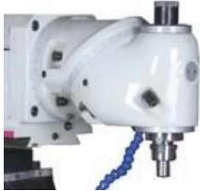
Die Senkrechte der Spindelachse zur waagrechten Oberfläche des Tisches kontrollieren und gegebenenfalls korrigieren. Wenn diese Bedingung nicht erfüllt wird, können beim Planfräsen Form- und/oder Geometriefehler auftreten. Wenn der Kopf zum Beispiel leicht längs geneigt ist, erzeugt die Fräse eine konkave Fläche (Abb. 1).
