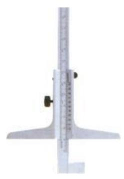
Tiefenmesser für die Messung der Tiefe von Keilnuten. Vorerst ist die Position der Spitzen auf dem zylindrischen Teil der Keilachse nachzustellen, um die Anzeige von Null zu erhalten.
