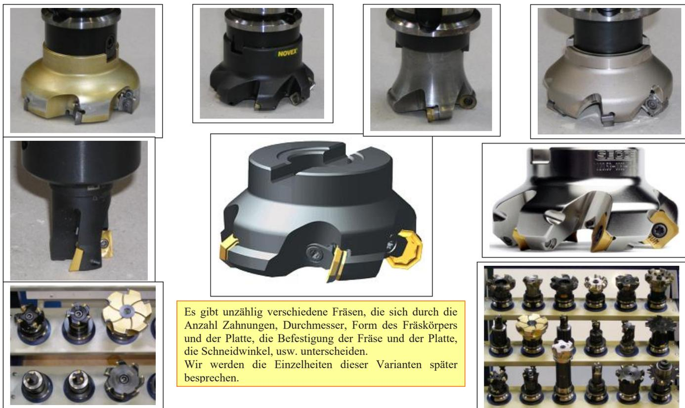
Es gibt unzählige verschiedene Fräsen, die sich durch die Anzahl Zahnungen, Durchmesser, Form des Fräskörpers und der Platte, die Befestigung der Fräse und der Platte, die Schneidwinkel, usw. unterscheiden. Wir werden die Einzelheiten dieser Varianten später besprechen.
