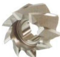
Für das Planfräsen,  $\frac{2}{3}$  des  $\varnothing$  der Fräse
